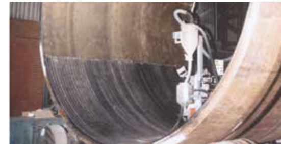
Separator Vessel (Nickel alloy 400) SOUDOTAPE NiCu7 + RECORD EST 400
