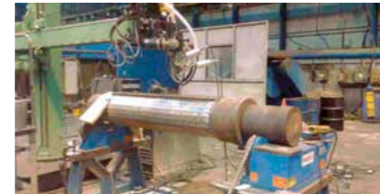
Forging - Punching Tools (Hastelloy C276) Barrier - SOUDOTAPE NiCrMo59 + RECORD EST 259 Finish - SOUDOTAPE NiCrMo4 + RECORD EST 259
