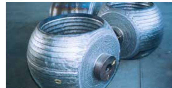
Ball Valves (Nickel alloy 625) SOUDOTAPE 625 + RECORD ES 6625
