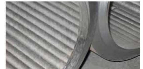
Pipes (Nickel alloy 825) SOUDOTAPE 825 + RECORD EST 825HS
