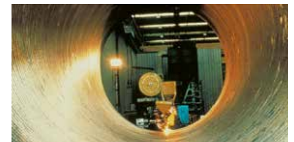
Separator Vessel (Nickel alloy 625) SOUDOTAPE 625 + RECORD ES 6625
