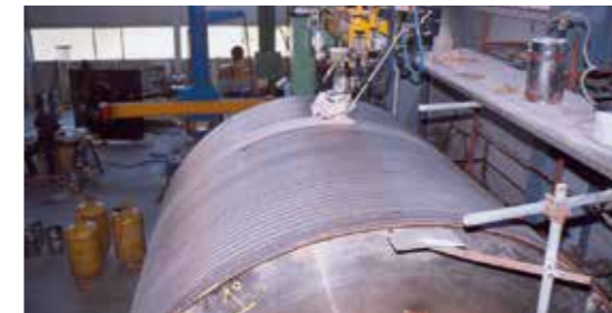
Paper Rolls (13 4 Mo) SOUDOTAPE 430 + RECORD EST 452
