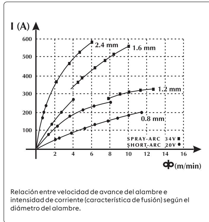
Relación entre velocidad de avance del alambre e intensidad de corriente (característica de fusión) según el diámetro del alambre.
