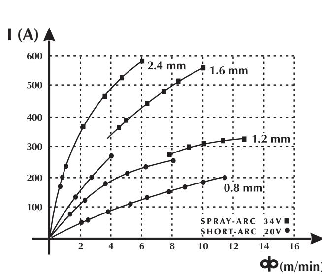
Relazione tra velocità di avanzamento del filo e intensità di corrente (caratteristica di fusione) in funzione del diametro del filo.
