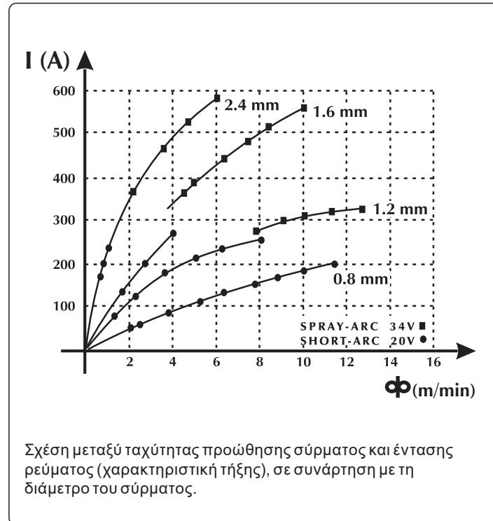
Σχέση μεταξύ ταχύτητας προώθησης σύρματος και έντασης ρεύματος (χαρακτηριστική τήξης), σε συνάρτηση με τη διάμετρο του σύρματος.
