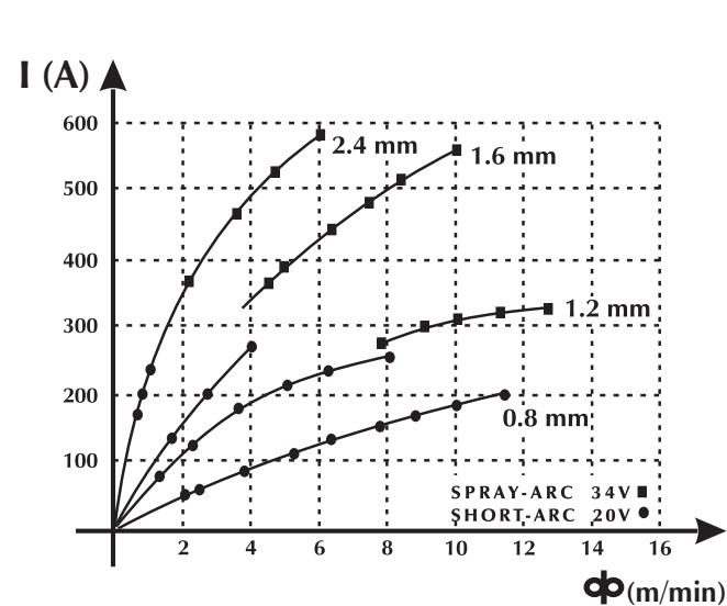
Forhold mellom matehastighet og strømnivå (fusjonskarakteristikk) i forhold på diameteren.
