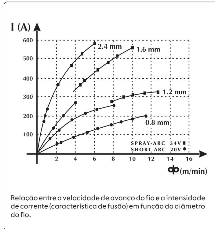
Relação entre a velocidade de avanço do fio e a intensidade de corrente (característica de fusão) em função do diâmetro do fio.
