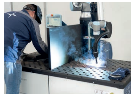
3 Tischtrennung, um die Arbeitsfläche in zwei Bereiche zu unterteilen: Schweißen Sie während Sie das nächste Bauteil programmieren.
