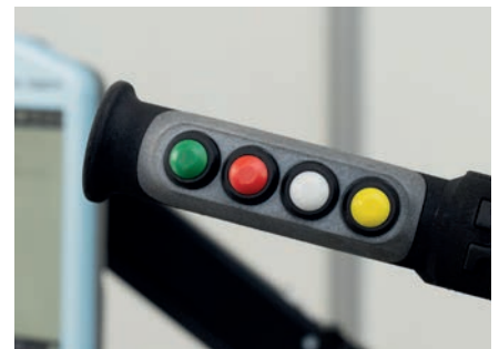
5 Kabelloses Handbedienteil: Grün – Punkte entlang der Schweißkontur hinzufügen, Rot – Schweißmodus ein- und ausschalten, Weiß – Bewegung des Roboters mit der Hand möglich, Gelb – Bewegungen außerhalb der Schweißkontur.
