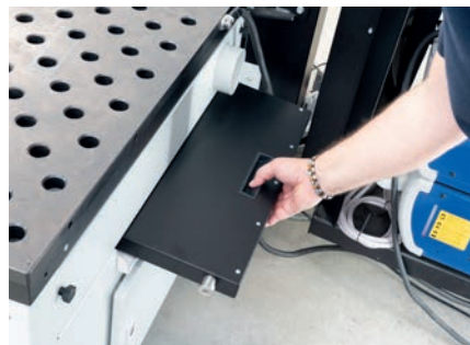
4 Tischtrennung, um die Arbeitsfläche in zwei Bereiche zu unterteilen: Positionieren und Schweißen.
