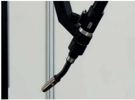
1 Robotergetützter MIG/MAG-Schweißbrenner für Schweißarbeiten bis 500 A.
