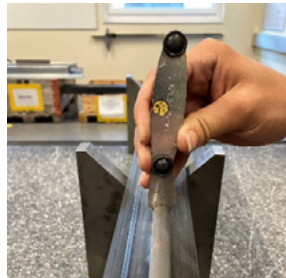
Messung des Radius durch Radienlehre Ergebnis: R_o
