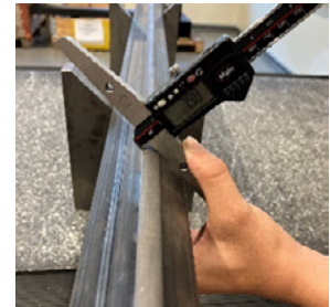
Messung der Radienkontur durch Messschieber Ergebnis: C_1, C_2
