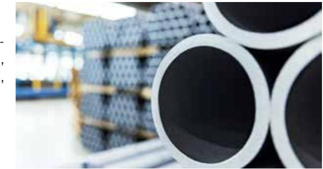
Abb.: Versandfertige Achsrohre in der Achsrohrfertigungshalle
