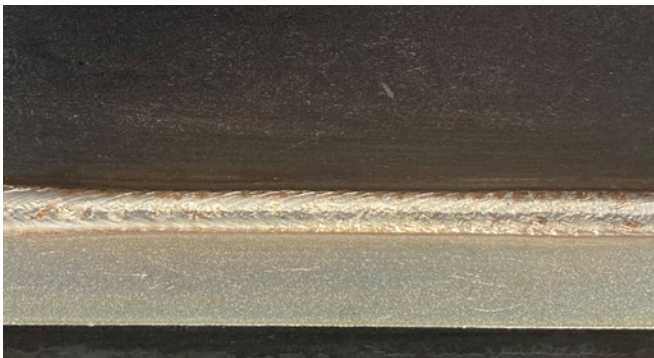
Soldadura en ángulo robótica de alta productividad utilizando alambre sin cobre ECOSPARK 420 y el proceso QuickPulse. Las imágenes muestran el perfil perfecto del cordón sin socavados, buena penetración, sin salpicaduras y muy pocos residuos, como islas de sílice, en la soldadura.
