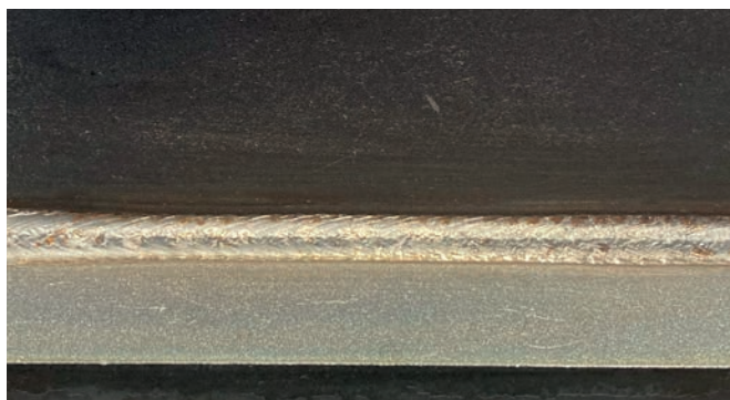
Soudure d'angle robotisée à haute productivité utilisant un fil sans cuivre ECOSPARK 420 et le procédé QuickPulse. Les photos montrent un profil de cordon parfait, sans creux, avec une bonne pénétration, sans projections et très peu de résidus tels que des silicates sur la soudure.
