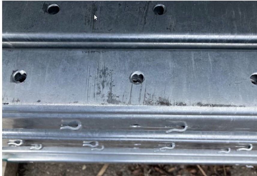
Abbildung 2: Kratzer an der Oberfläche durch Manipulation mit dem Gabelstapler
