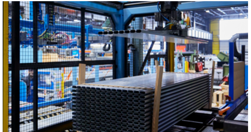
» Automatisches Sortieren und Bündeln
